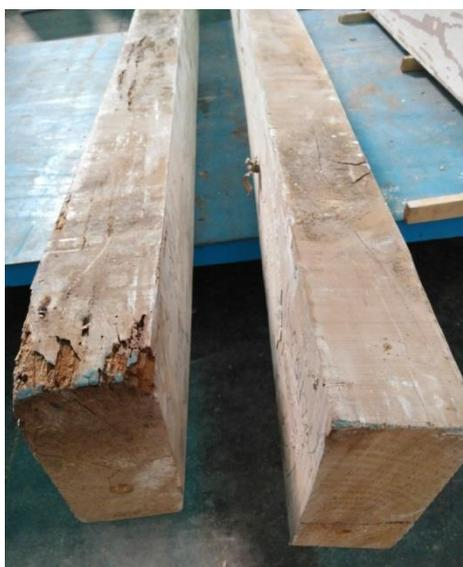
**Imagen 1. Elementos apeados de la estructura de un edificio histórico en Denia para su análisis en el proyecto. El deterioro que presentan es meramente superficial y no afecta a su resistencia mecánica.**
