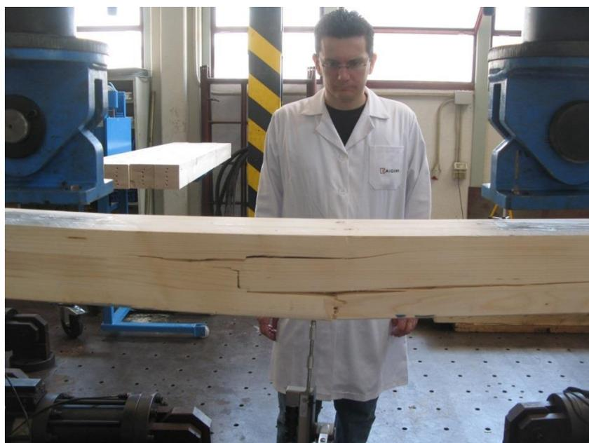
**Fotografía 3. Rotura de una viga de madera en un ensayo a flexión según la norma UNE-EN 408, mediante máquina universal de ensayos. Muy raramente pueden realizarse estos ensayos destructivos en madera antigua y patrimonial; y para madera nueva tienen un coste muy elevado y se desaprovecha material.**
