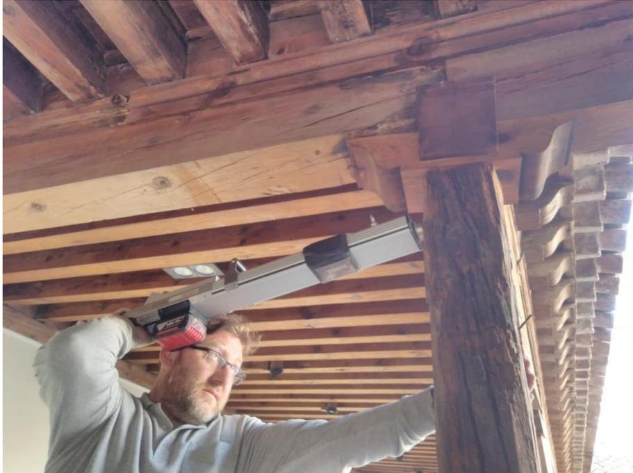
Fotografía 4. Ensayo in situ mediante la técnica no destructiva de resistografía para detectar deterioros en el elemento y determinar su sección efectiva.
